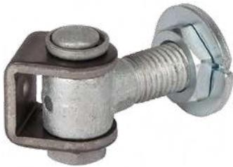
Charnière à 90° galvanisée à chaud avec système anti-dégondage. Elle est la solution idéale pour tous vos portails industriels de petite et moyenne taille. La douille à souder vous permet de régler la charnière.
