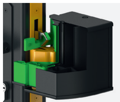
L'association du lardon et du centreur empêche le soulèvement du portail. La réversibilité du lardon permet de convertir aisément un portail manuel en portail motorisé.
